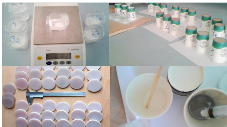
الشكل (3): عينات من البولي استر - غير النقي المعزز بكربونات الكالسيوم النقية وقشور البيض.
